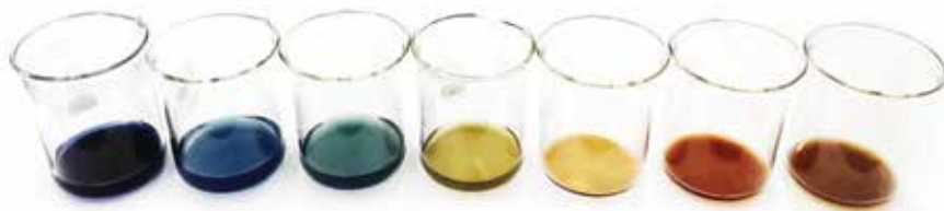
Figura 4. Resultados de la decoloración del efluente luego del tratamiento con varias cantidades de material adsorbente de cáscara de banana
