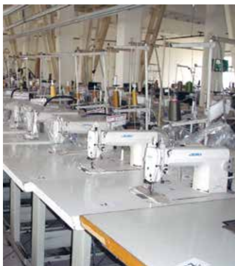
Figura 5. Máquina de coser industrial triple habilitada para lonas, toldos, piel
