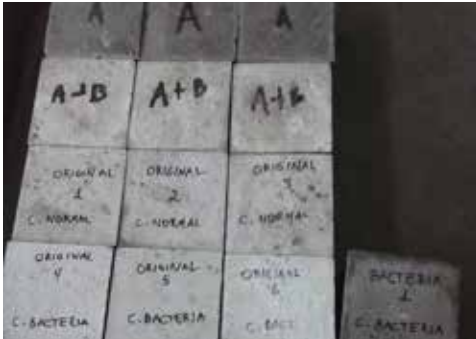
Figura 3. Experimentación con diversos materiales de construcción y curado de bacterias
