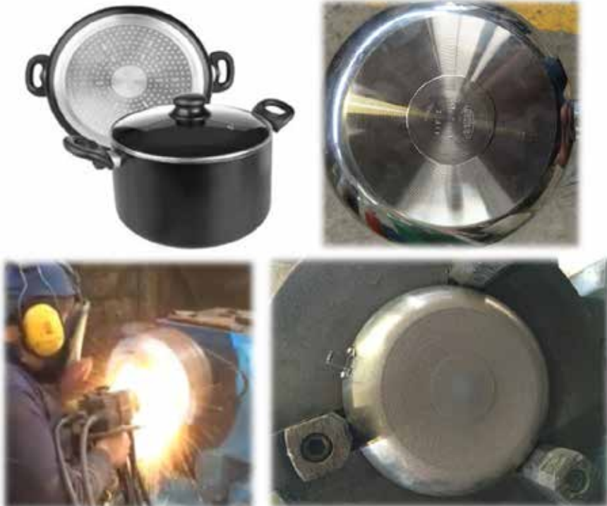
Figura 4. La figura muestra utensilios de cocina hechos de aluminio como materia prima: (arriba-derecha) se muestra una olla con inserto de acero inoxidable en la base para producir la inducción, (arriba-izquierda) se muestra el acabado superficial de la base de una olla de aluminio sin inserto; (abajo-derecha) se observa la prueba exploratorio de depósito de un recubrimiento de acero inoxidable por termorociado; y (abajo-izquierda) se muestra el recubrimiento sobre la base de una sartén.
