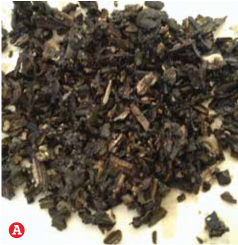
Figura 6. Material absorbente filtrado luego del tratamiento a) pedazos b) en polvo
