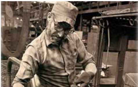
Figura 1. En la figura, se muestra la técnica del repujado para producción de utensilios de cocina de forma artesanal (derecha-arriba-abajo). Las propiedades de ductilidad del aluminio permiten su fácil conformado. El cambio a material de acero inoxidable impide el uso de las mismas técnicas por la alta resistencia a la deformación del mismo. Se muestra la técnica de termorociado para proyectar partículas fundidas de material ferromagnético (izquierda-arriba). También se muestran la emisión de toneladas de \text{CO}_2 para la producción de distintos materiales incluyendo madera, acero, plástico PVC y aluminio.
