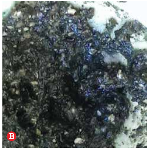
Figura 6. Material absorbente filtrado luego del tratamiento a) pedazos b) en polvo
