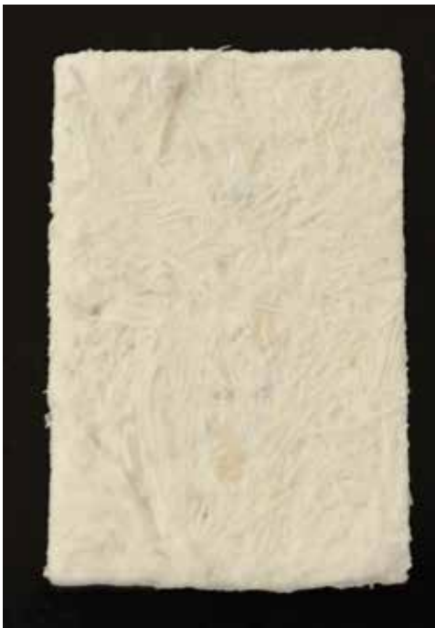
Figura 2: Papel obtenido mediante el método químico artesanal.
