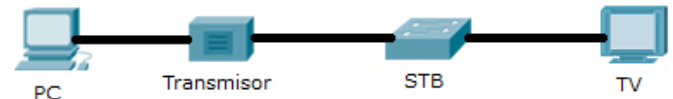
Figura 9. Escenario de pruebas de los flujos únicos de paquetes de transporte TS generados
