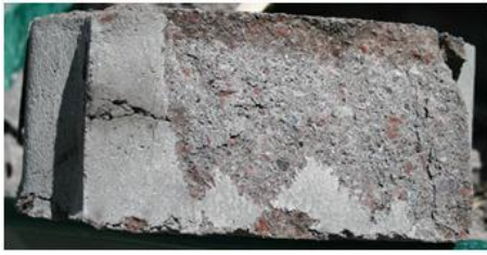
Figura 11. Plano de fractura de un adoquín tradicional
