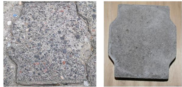
Figura 16. Superficie de rodadura de un adoquín desgastado (izq.) y de uno nuevo (der.).
