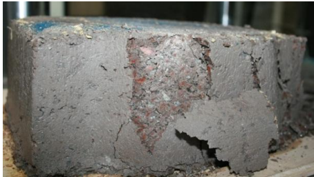
Figura 12. Plano de fractura de un adoquín con vidrio grueso ensayado a compresión.
